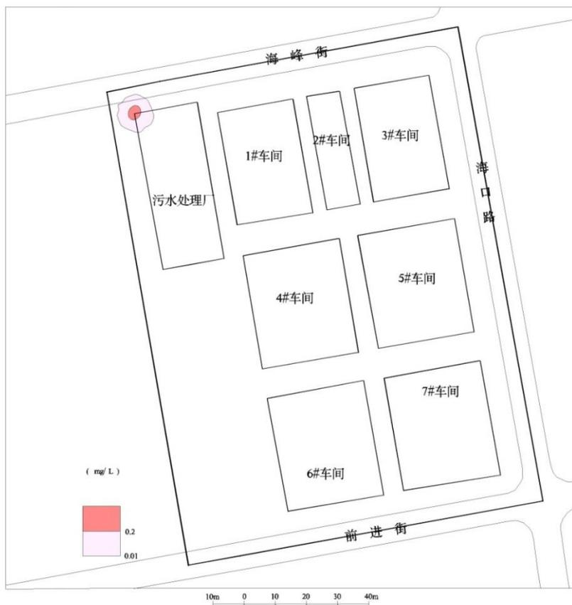
图 5.4-10-4 点源连续污染 30d 后氨氮污染预测图
