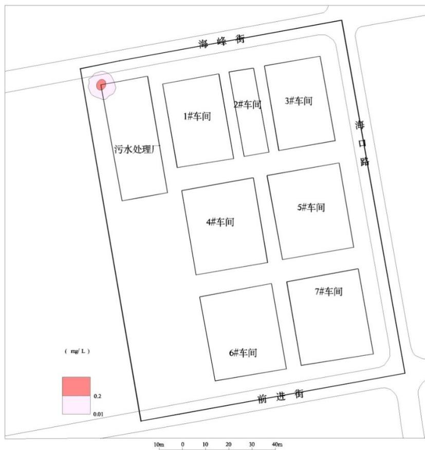
图 5.4-10-5 点源连续污染 100d 后氨氮污染预测图
