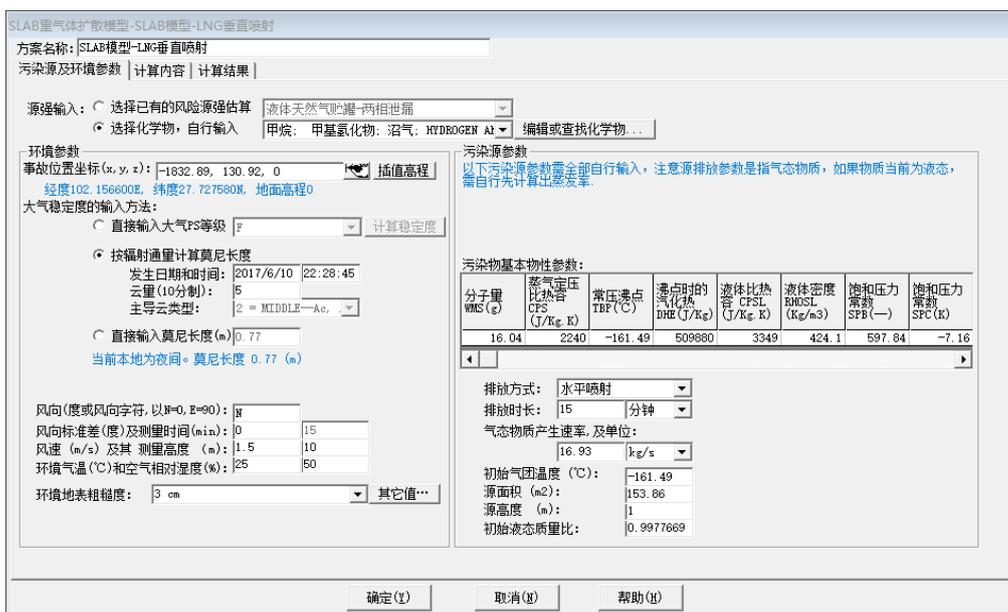
图 6.5-3 SLAB 模型污染源及参数截图
