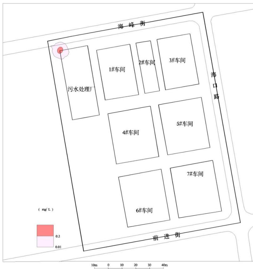
图 5.4-10-6 点源连续污染 365d 后氨氮污染预测图
