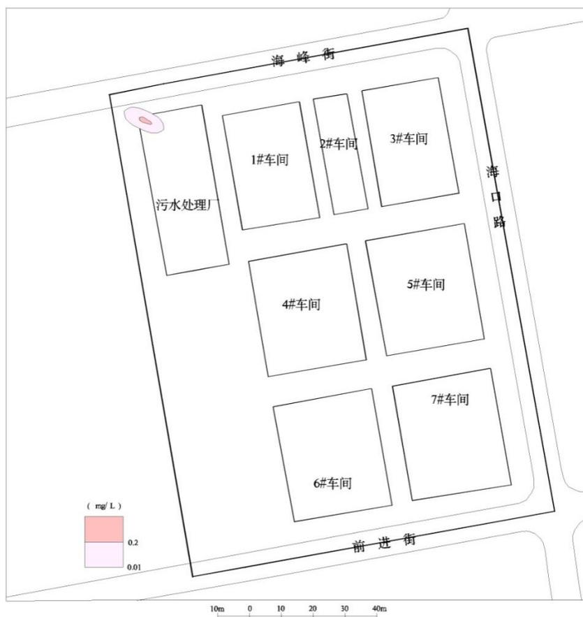
图 5.4-9-5 点源瞬时污染 30d 后氨氮污染预测图
